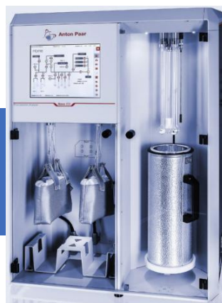
Figura 17. Analizador de área de superficie y tamaño de poro NOVA 600 BET.
