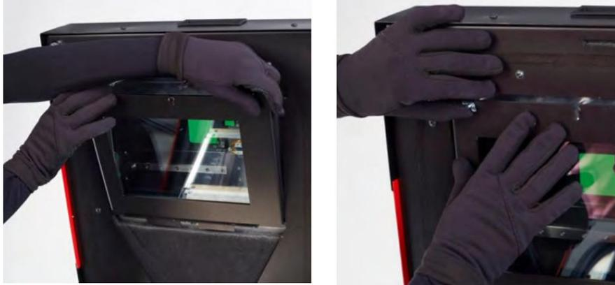
Imagen 16. Correcta colocación del VIDRIO DE PROTECCIÓN LÁSER sobre el módulo calefactor.
