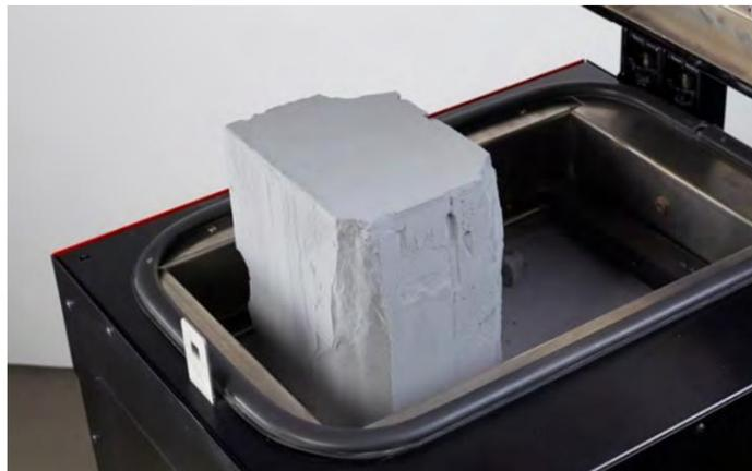
Imagen 38. Correcto estado del polvo tras la impresión (fisuras visibles en las superficies de ambos BED).
