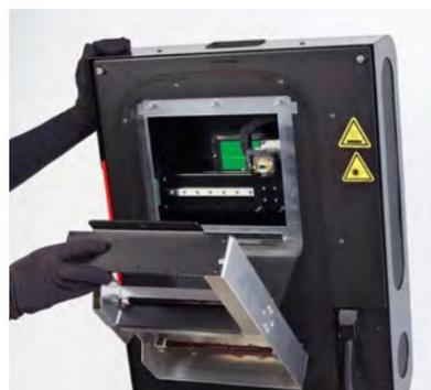
Imagen 13. Módulo calentador - apertura.
