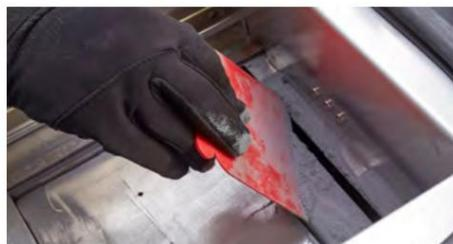
Imagen 48. Eliminación de polvo de PRINT BED a OVERFLOW BIN.
