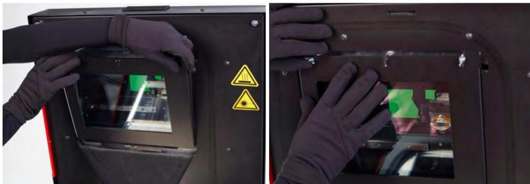
Imagen 58. Correcta colocación del VIDRIO PROTECTOR LÁSER en el MÓDULO CALEFACTOR.
