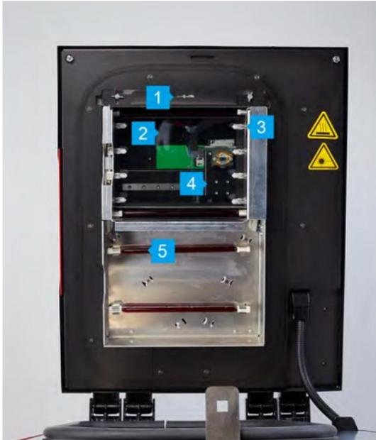
Imagen 5. Vista del módulo calentador de la impresora.
