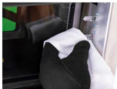
Imagen 62. Eliminación correcta de los viejos y instalando los nuevos CALENTADORES INFRARROJOS.
