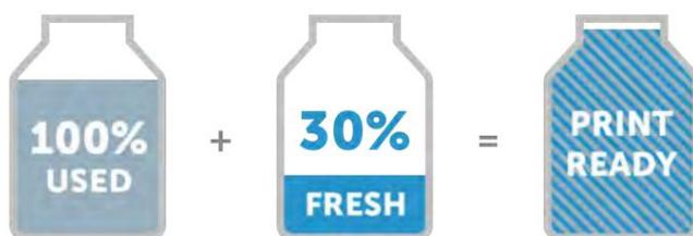
Imagen 56. El método de combinación de PA12 con tasa de refresco del 30% después de la impresión.
