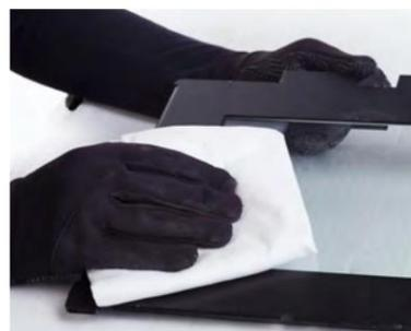
Imagen 15. Limpieza de CRISTALES DE PROTECCIÓN LÁSER.
