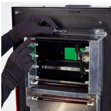
Imagen 12. Módulo calefactor - sistema split pin.
