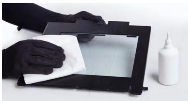
Imagen 59. Limpieza de cristales de protección láser.
