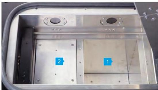
Imagen 23. Camas reposicionadas: Cama de IMPRESIÓN (2) y lista para llenar con polvo BANDEJA DE ALIMENTACIÓN (1) y la posición base para RECUBRE.
