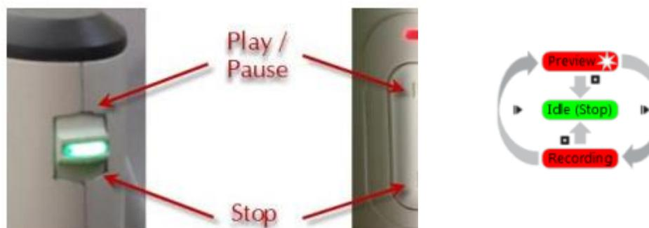
✓ Indicadores LED de los escáneres Eva/Spider. Según el color y parpadeo del LED se puede realizar un seguimiento del proceso de escaneo:
